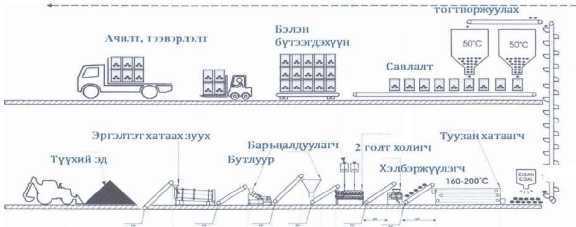
Зураг 4. Шахмал түлш үйлдвэрлэх схем
