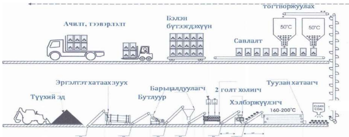
Зураг 5. Шахмал түлш үйлдвэрлэх схем
